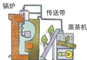
自动将收集到的茶叶送到蒸茶机上蒸制。
