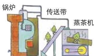
自动将收集到的茶叶送到蒸茶机上蒸制。
